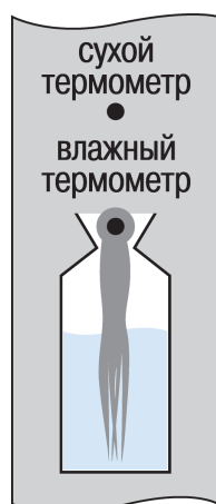
Рисунок К.3 – Форма резервуара с «бутылочным горлом»
