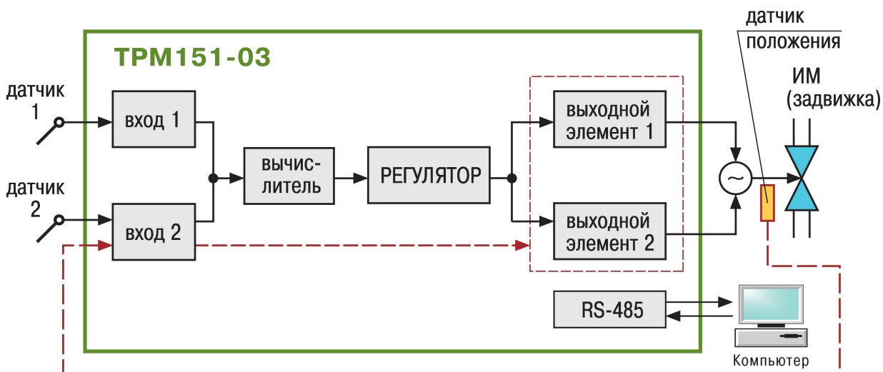
Рисунок 4.3 – Принципиальная схема модификации 03 прибора TPM151
